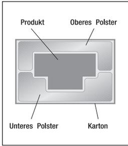
Die Polsterung entsteht durch schaumgefüllte **Instapak Quick® RT** Beutel, wobei das Produkt zwischen zwei oder mehreren ausgedehnten Beuteln gesichert wird.
