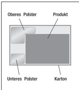
Das Material zum Blockieren und Fixieren wird beim Verpacken von robusten Produkten angewandt, die vor Gleiten oder Verrutschen innerhalb des Versandkartons geschützt werden sollen.
