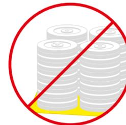
Hohe Schichtdichten verhindern einen homogenen VCI-Austausch. Zusätzliche VCI-Zwischenlagen verwenden!
