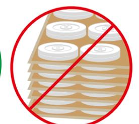
Direkten Kontakt von Metall zu Materialien, die korrosionsfördernde Substanzen enthalten können (z. B. Holz, Papier, Pappe), vermeiden! Auch Zwischenlagen sollten mit VCI abgedeckt werden.
