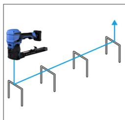
automatisches Heften: Heftklammern werden bei gedrücktem Auslöser innerhalb eines vordefinierten Zeitraums fortlaufend gesetzt.
