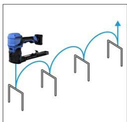
halbautomatisches Heften: Heftklammern werden bei gedrücktem Auslöser fortlaufend gesetzt.
